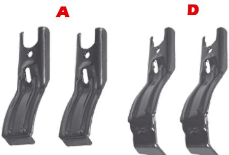
① Montare le 2 staffe **A/D**, inserire la brugola con il dado e avvitare.
