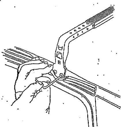
① Spostare le guarnizioni delle portiere o, se non si riesce, sfilare completamente ed inserire barre e staffe in corrispondenza dei fori filettati già esistenti sulla vettura. (vedi disegno).
