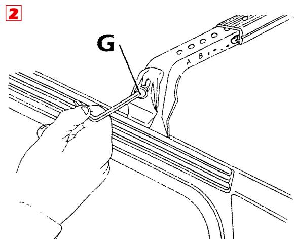
(I) Spostare le guarnizioni delle portiere o, se non si riesce, sfilare completamente ed inserire barra e staffe in corrispondenza dei fori filettati già esistenti sulla vettura. (vedi disegno).
