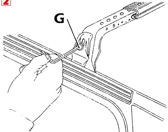
**(I)** Sfilare le guarnizioni delle portiere ed inserire le staffette **A** nel perno posteriore già esistente sulla vettura (vedi disegno 1). Serrare quindi con forza le 4 brugole **G** (vedi disegno 2).
