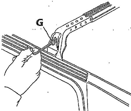
**(4)** Entfernen Sie die Türleisten, oder wenn das nicht möglich sein sollte, entfernen Sie sie vollständig und setzen Sie die Stangen und Bügel so ein, daß sie mit den bereits auf dem Auto vorgegebenen Bohrlöchern übereinstimmen (siehe Zeichnung). Ziehen Sie 4 Schrauben **E** und **G** fest an.
