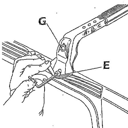
**(1)** Spostare le guarnizioni delle portiere o, se non si riesce, sfilare completamente ed inserire barre e staffe in corrispondenza dei fori filettati già esistenti sulla vettura. (vedi disegno).
