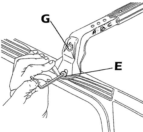
**I** Spostare le guarnizioni delle portiere o, se non si riesce, sfilare completamente ed inserire barra e staffe in corrispondenza dei fori filettati già esistenti sulla vettura. (vedi disegno).
