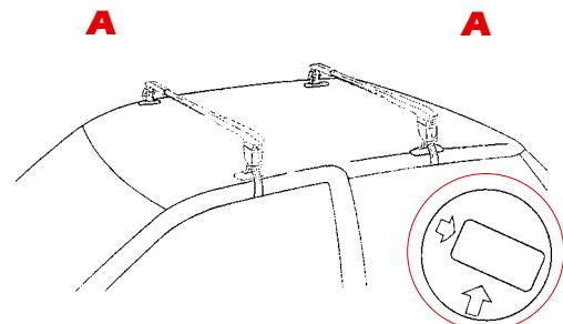
① Montare le 4 staffe **A**, inserire la brugola con dado e avvitare. **Attenzione:** montare i piedini in gomma (anteriore e posteriore) come indicato in figura.
